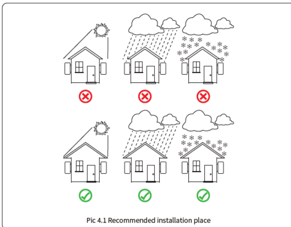
Kuva 4.1.1 Invertterin suositellut asennuspaikat rakennuksen julkisivulla.
