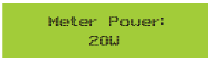
Kuva 7.2.3 Nollaviennin toiminto energiamittarin kautta päällä.
