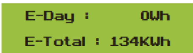
Kuva 8.1.6 E-Day : Päivittäinen tuotanto; E-Total : Kokonaistuotanto.
