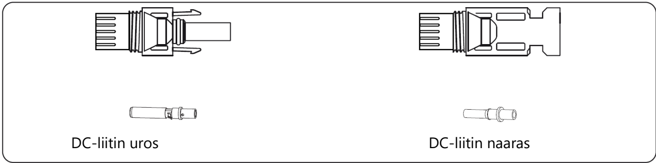
Kuva 5.2.4 Havainnekuva tasavirtapuolen uros- ja naaraspuolen liittimistä.
